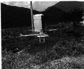
空中写真測量ラジコンヘリ
