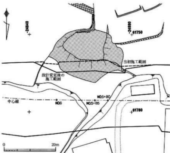
1図 設計変更後の施工範囲図(1:600)
