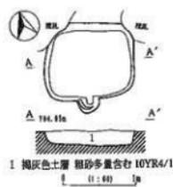
第 147 図 D106 号土坑実測図
