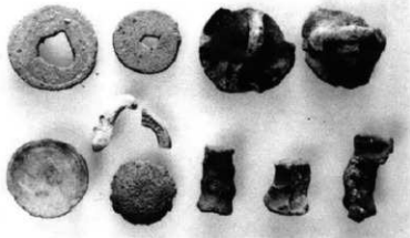
窯道具のいろいろ……右からツク・サヤ・枕（長さ16cm・幅10cm・厚さ6cm）
