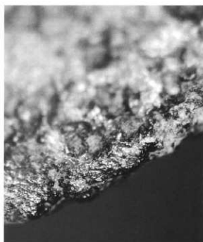
2B 刃縁の摩耗・光沢面(2Aの拡大) × 22.5
