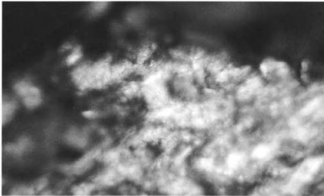
E 刃部の摩耗・光沢痕(NaCl) ×100
