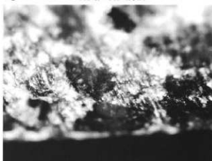
1D 刃部の摩耗・線状痕(1Cの拡大) × 30
