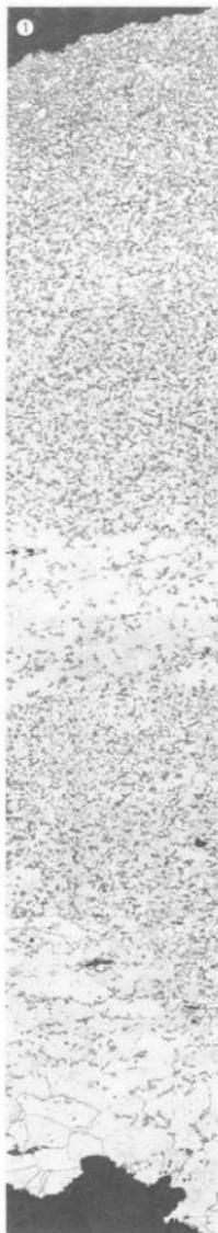
Photo. 3 浪巻文装飾付鉄鋼の顕微鏡組織 (×1,000, 縮小0.6)
