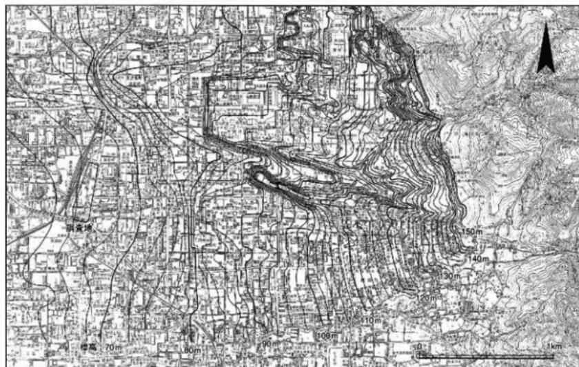
主曲線：2m間隔、計曲線：10m間隔
