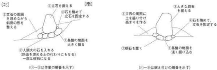
第66図 東～南汀線立石据付断面模式図
