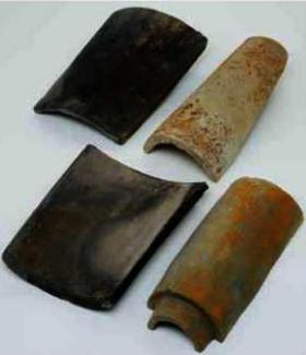
熨斗瓦は、2枚分の粘土を用いた粘土板を、縦半分にして作る。窯に入れて焼きあげる前に縦半分にするものもあれば、焼く前に分割用刻み線を施しておき、焼成後に半分に打ち割るが、なんらかの事情で2分割せずそのまま使用したものもある。また平瓦を縦半分にして転用する場合もある。
