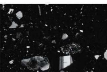
Qz:石英。 PI:斜長石。 Opx:斜方輝石。 Cpx:單斜輝石。 Ho:角閃石。 Ry:流紋岩。
