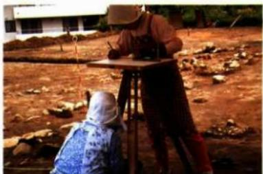
平板による平面図作成作業
