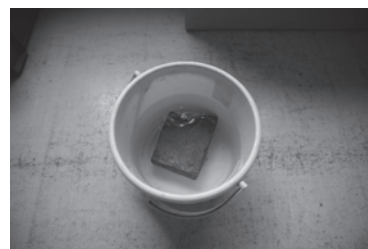
モルタル除去後、煉瓦を水に浸けて溶剤を抜く
