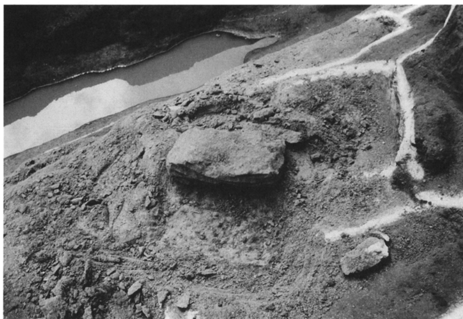
写真2 採掘実験で採取した構築材（凝灰岩）
