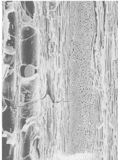
2b コナラ節 (接線断面) 資料番号A5-13 bar:0.5mm
