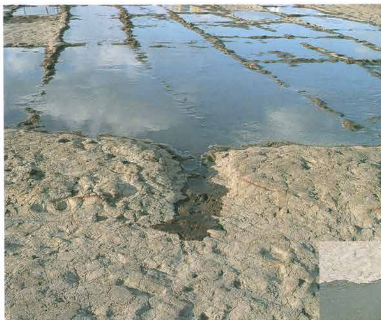
極小区画水田における流水実験（手前から奥へ流下し大畦畔でストップ。大区画内が湛水するまで、下位の大区画へ流下しない）
