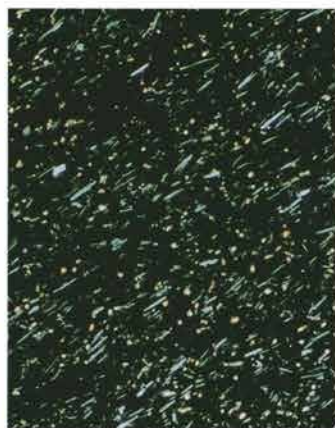
黒色安山岩のプレパラートの偏光顕微鏡写真(2) (a, c: 平行ニコル b, d: 直交ニコル×50)
