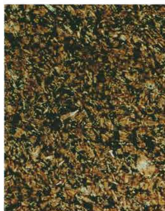
黒色安山岩のプレパラートの偏光顕微鏡写真(2) (a, c: 平行ニコル b, d: 直交ニコル×50)
