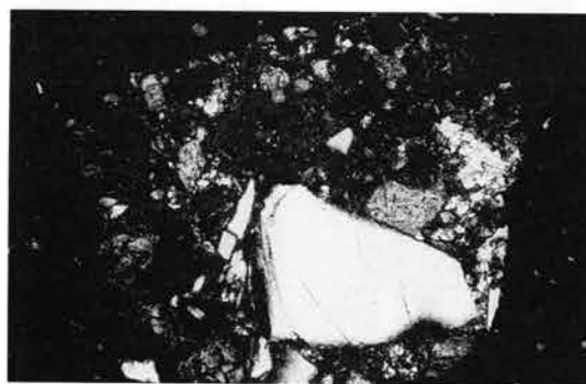
2. IH-051中の岩石片の顕微鏡写真(上:単ニコル、下:直交ニコル)。堆積岩起源の岩石片(砂岩?)と思われる。スケールは0.2mm。
