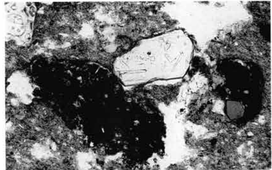
2. IH-051中の火山岩片の偏光顕微鏡写真(上:単ニコル、下:直交ニコル)。斜長石斑晶と完晶質の石基からなる岩石片。中央上端に軽石質岩石片もみられる。スケールは0.25mm。
