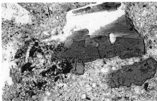
1. IH-054中の火山岩片の偏光顕微鏡写真 (単ニコル)。角閃石斑晶に微細な石基が付着している。スケールは0.1mm。
