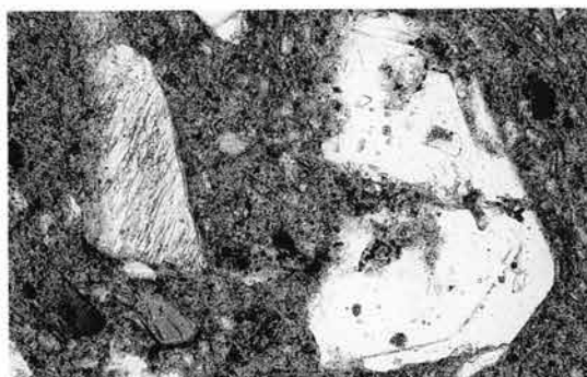
4. IH-054の偏光顕微鏡写真 (単ニコル)。右の斜長石は自形結晶の破砕片であり、内部に褐色ガラスを包有している。左にアルカリ長石がみられ、その下に褐色および暗褐色を示す角閃石2片がみられる。スケールは0.2mm。
