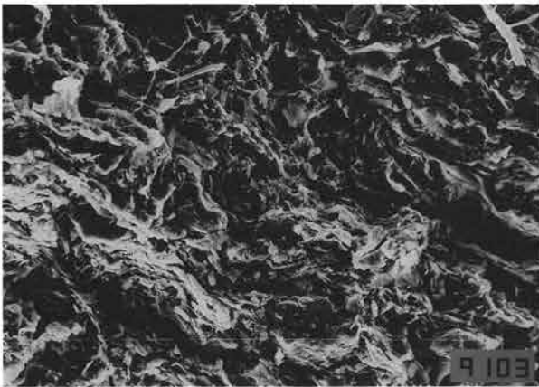
北三木堂 No 3 1. 粗粒砂を混入する碎屑性粘土 2. 原土の組織を残す 3. マトリックスは n\text{Al}_2\text{O}_3 \cdot m\text{SiO}_2 \cdot l\text{H}_2\text{O} + \text{grass} 4. grassは細粒で、焼成ランクはIII
