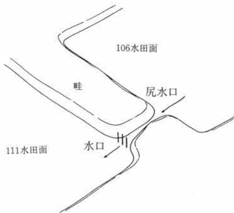
第196図 111水田面水口施設模式図
