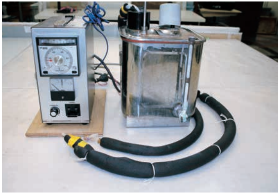
蒸気発生装置
