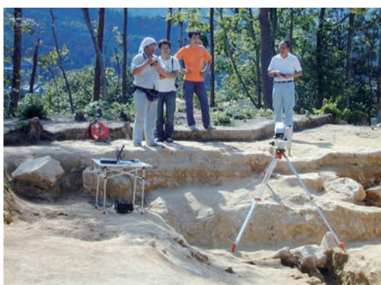
写真54 墳丘の3D計測状況
