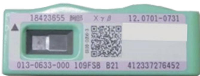
ガラスバッジは特定の個人専用で使うものですので、一人一人の被ばく線量を測定する装置として有効です。
