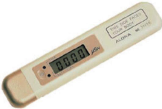
個人が受けた放射線量をその場で確認できるのがポケット線量計です。電源を切るまで、数値が積算されます。追加の被ばく量をモニターするものなので、日常的に勤務している場所から出発するときに電源を入れ、帰着するまで電源を入れっぱなしにして、数値を読んで記録します。帰着したら数値を記録後に電源を切ります。
