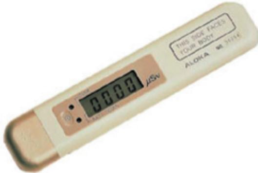
個人が受けた放射線量をその場で確認できるのがポケット線量計です。電源を切るまで、数値が積算されます。男性は胸部、女性は腹部に液晶表示面を体側に向け装着します。携帯電話等、電子機器類の発する電波に反応するので同じポケットに入れず20 cm以上、離して使用します。
