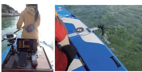
図5 スキャンソナー機材とRTK-GNSS
