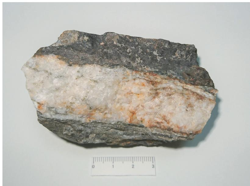
図3 岩盤の裂縫を充填した含金石英脈（女牛金山蓬来鉱床）
