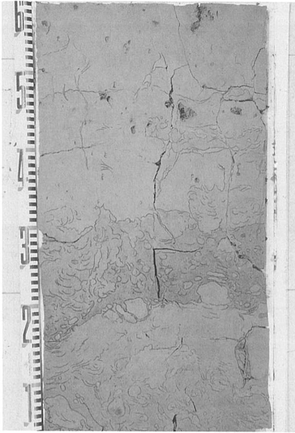
図VII-13 不攪乱試料14Ctr.(a)とその軟X線写真
