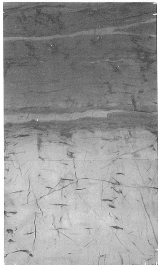
図VII-18 不攪乱試料18A tr.とその軟X線写真
