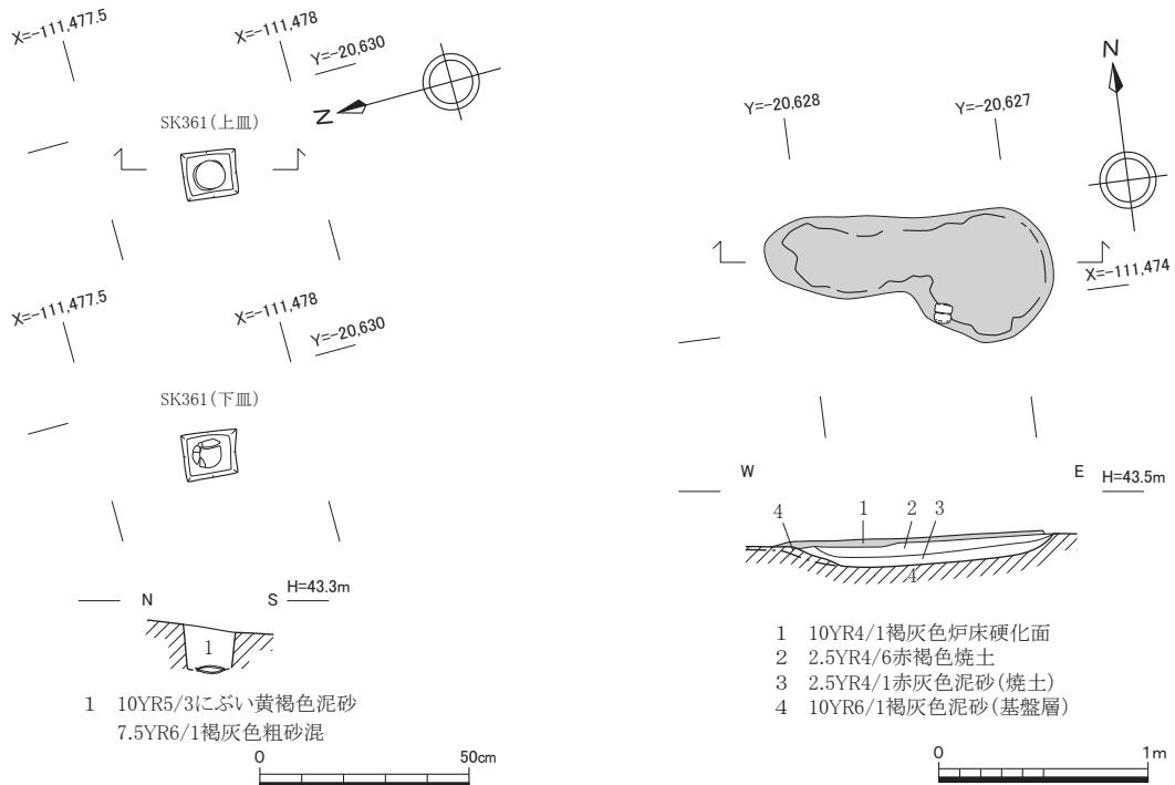
図28 埋納遺構 361 平面・断面図 (1 : 20)
