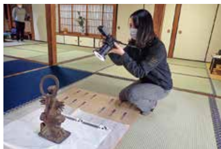
（図22）仏像の三次元計測調査の様子
