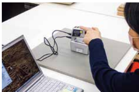
（図21）摩擦係数実験の様子
