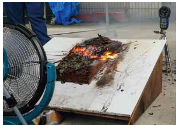
図51 檜皮葺きの燃焼実験風景
