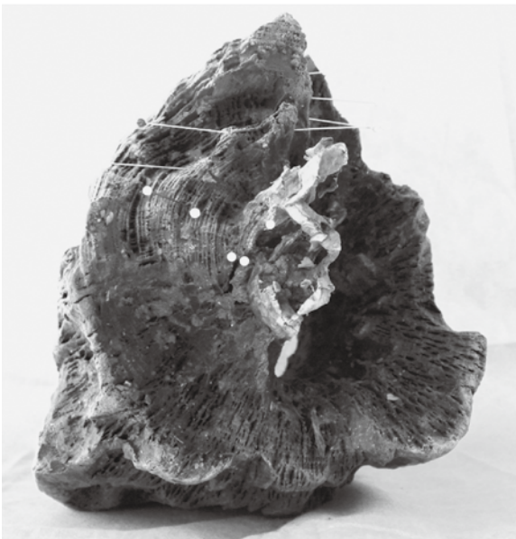
柱材 No. 1 (SB304・P1) 破断面 (木口)
