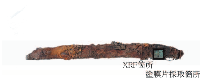
図 30. No. 6801小刀のXRF箇所（□印）と採取箇所（○印）
