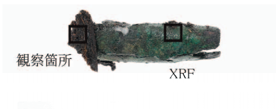
図 45. No. 9321 筒状銅製品のXRFと微小部観察箇所
