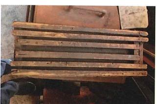
17 錆止め乾燥用台
