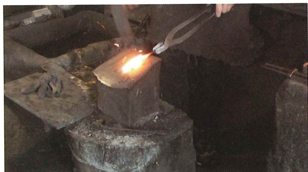
3-4 アラツクリ (鍛造) 鍛接剤を付けた先端部分の鍛造を行い、鋼を完全に鍛接して穂の成形を続ける
