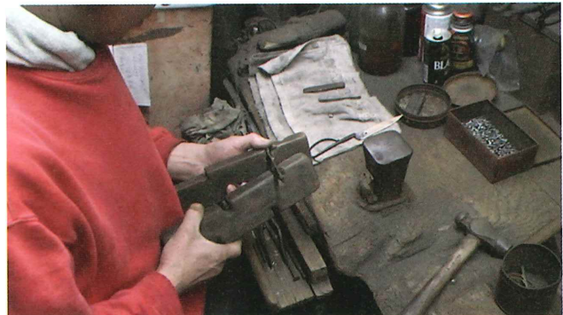
21-1 カシメ 目釘で組み上げる前に湾曲やねじれの状態をクネリギによって調整する
