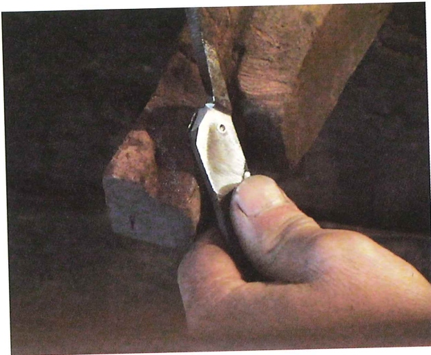
図13 スリ板に固定してスリアワセ面の切削
