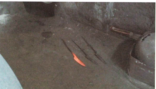
3-11 アラツクリ (鍛造) 鍛造成形の終了後、穂を再度加熱して空気中に放置 (徐冷) し、鋼の焼鈍を行う
