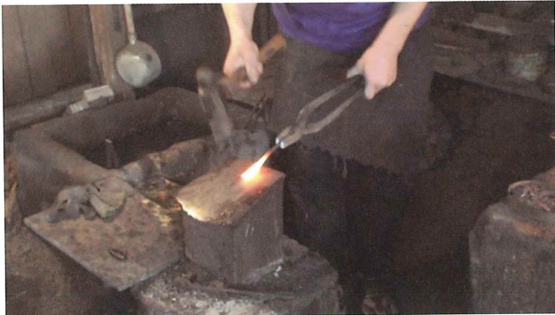
2-1 ワカシツケ (鍛接) 穂の部分を加熱し、鋼 (高炭素鋼) を鍛接するために四角の形を整える
