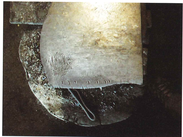
図8 金床カガミ面に刻まれた長さの目安
