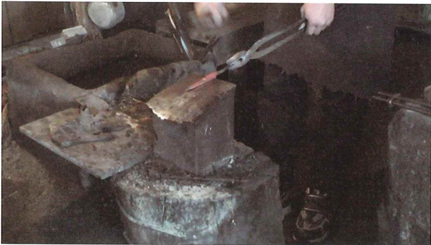
3-7 アラツクリ (鍛造) 水打ちを繰り返し、オモテの部分を整える
