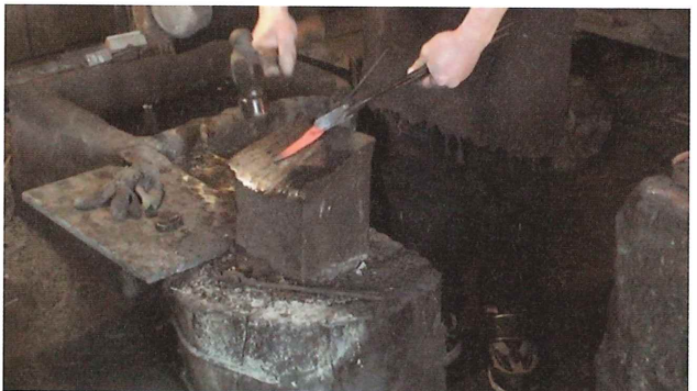
3-10 アラツクリ (鍛造) 穂に湾曲とねじれを加える
