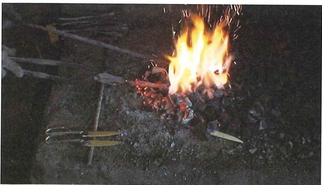
13-2 焼入れ 火床手前で焼き刃土を乾燥させた後、穂の刃側を下に向けてホド内に入れ、加熱する
