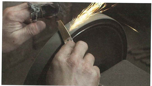
18-5 ミガキ (仕上げ) 穂の後シノギを切削する
