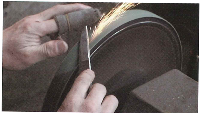
18-3 ミガキ (仕上げ) 穂のウラを切削する
