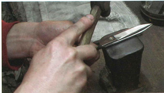
21-2 カシメ 目釘を小槌でカシメ打ち、一挺の鋏に組み上げる
