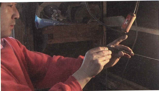
4-6 ナラシ 穂の湾曲とねじれ、スリアワセ面などを確認する
