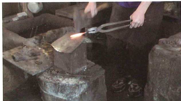
3-2 アラツクリ (鍛造) ウデとスリアワセ面の境目を作るために金床の手前端で段差を作る
