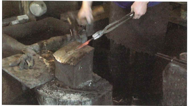
3-6 アラツクリ (鍛造) 水打ちを繰り返し、穂の形を整える
