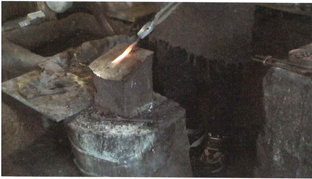
3-5 アラツクリ (鍛造) 水打ちにより酸化膜を剥離させて表面を滑らかにし、オモテをはじめ各部分を成形する
