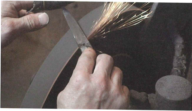
17-5 アラミガキ 穂の後シノギを切削する
