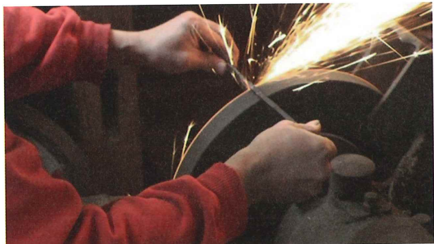
5-3 スリアワセ (切削) ウデの元部を切削し、その形を決定する
