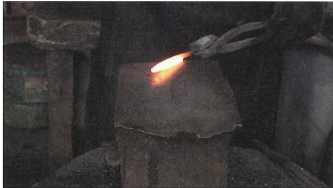
2-7 ウデとスリアワセ面の段差位置を決定 — 854℃ 穂の形に近づけた後、ウデとスリアワセ面の境に段差を作る
