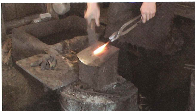
3-1 アラツクリ (鍛造) 穂の形に鍛造する
