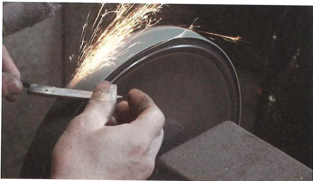
18-2 ミガキ (仕上げ) 穂の前シノギを切削する
