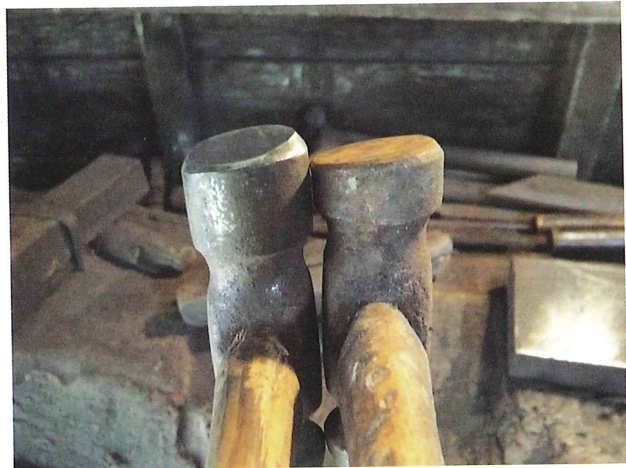
図2 金槌におけるカガミ面の傾斜の違い 梅木氏の金槌（左）と牧瀬氏の金槌（右）
