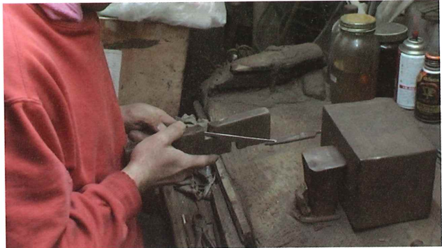
11-1 ウデマゲ クネリギによってウデの元部を緩やかな曲線に曲げる
