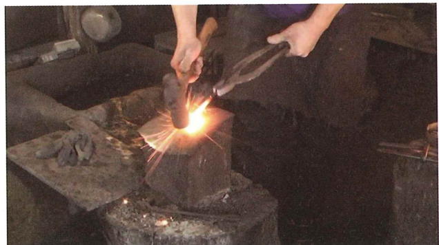
2-4 ワカシツケ (鍛接) 鋼全体を弱い力で加圧して接合した後、強打して鍛接を完全に行う
