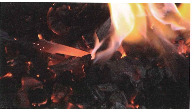
13-3 焼入れ ホド内で穂を前後させて温度むらをなくすと同時に焼入れ温度に達するまで加熱する
