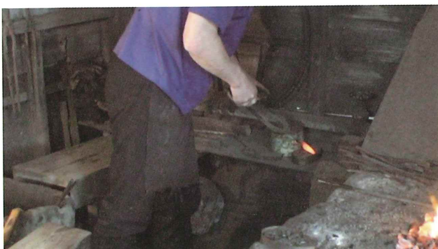
3-3 アラツクリ (鍛造) 先端の鋼を完全に鍛接するため、再度鍛接剤を付けて鍛造する
