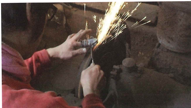
12-1 ナマト 焼入れ前に穂の切削（# 36の砥石）を行う 最初に刃のラインを切削する
