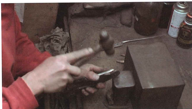
11-4 ウデマゲ ウデマゲ型から浮いた部分を小槌で打ち、型に密着させる
