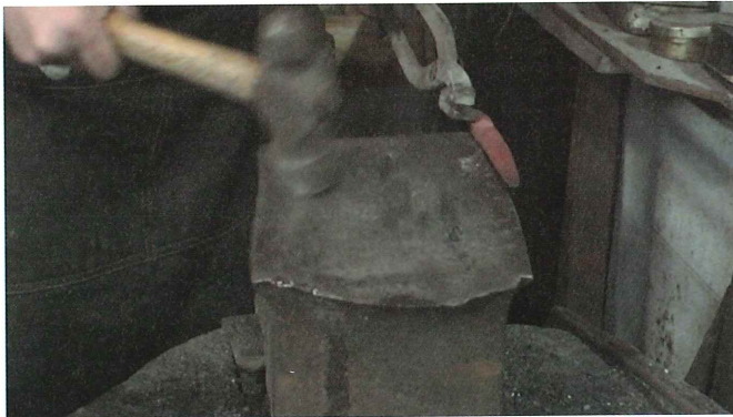
3-11 穂の長さ確認（その後火床へ移動） — 707℃ 穂の長さを確認後、4回目の加熱を行うため火床へ移動する
