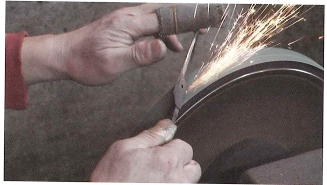
18-1 ミガキ (仕上げ) 穂の刃の部分 (ライン) をベルトサンダー# 80、# 240 で切削する
