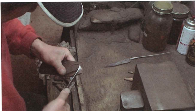
11-2 ウデマゲ ミナジリをウデマゲ型に固定し、型の曲線に合わせて曲げる
