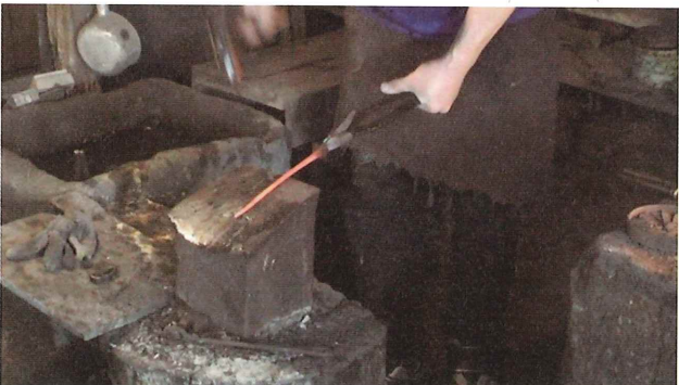
3-9 アラツクリ (鍛造) ウデの鍛造を行う 水打ちをし、表面を滑らかにすると同時に形を整える
