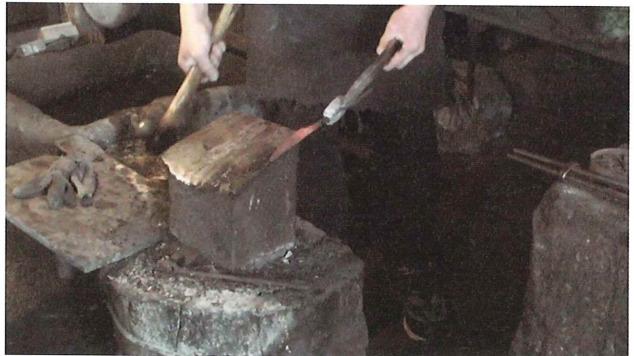
3-8 アラツクリ (鍛造) 穂の長さの確か、金床の目印で確認する 長い場合は鑿で切断する
