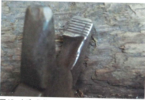
図15 ウデの調整用に変形させたペンチ
