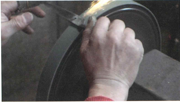
18-6 ミガキ (仕上げ) 穂の座を切削する
