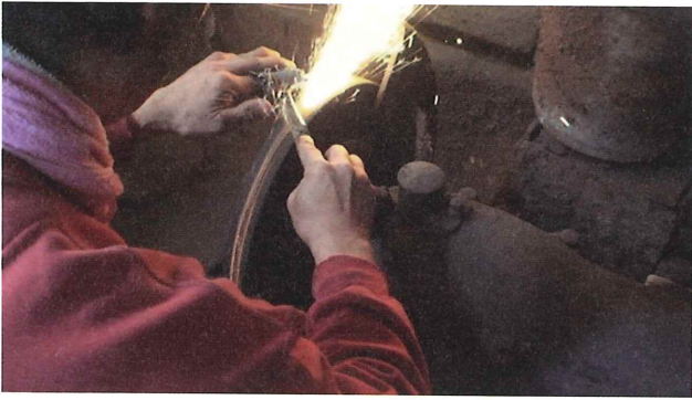
12-3 ナマト 穂のウラを切削する 砥石面に対して斜目に当てて湾曲とねじれに沿って切削する
