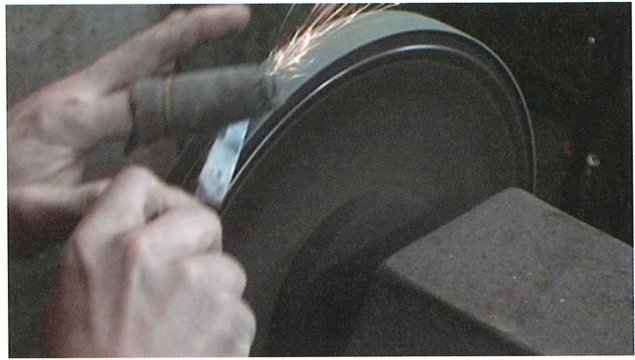
18-7 ミガキ (仕上げ) 穂のミネを切削する
