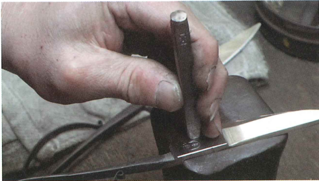
19-1 刻印 座の面に「本種」と作者銘である「梅」の刻印を打つ
