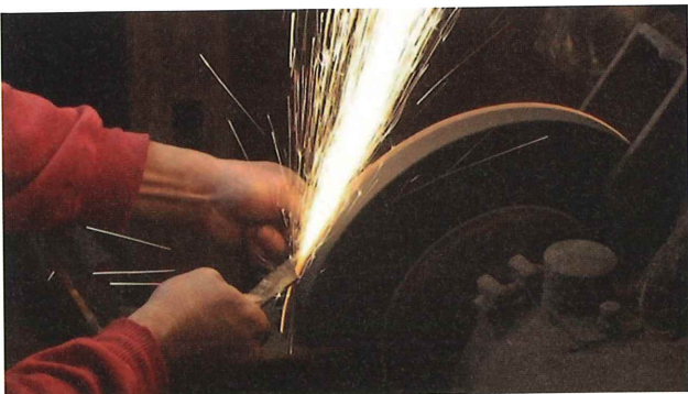
5-2 スリアワセ (切削) スリアワセ面のアゴ部を切削し、外形を決定する
