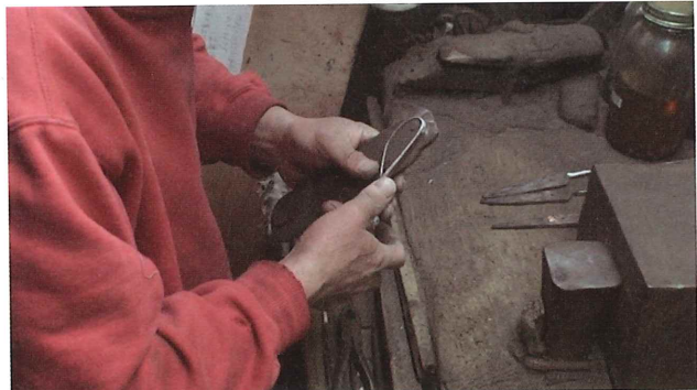
11-3 ウデマゲ 型の曲線に合わせてさらに曲げる
