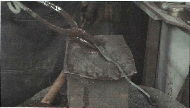
4-15 火床へ移動（穂に持ち替えて） — 580℃ 穂に持ち替えて5回目の加熱を行うため火床へ移動する
