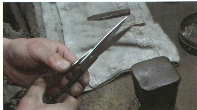
21-3 カシメ 穂を回転させて相互の刃の擦り合わせ抵抗やその音などでカシメの強さを確認する
