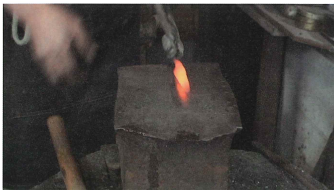
2-8 火床へ移動 (3回目の加熱) — 815℃ 段差に従ってスリアワセ面を整え、穂の先端に鍛接剤をつけて火床へ移動する
