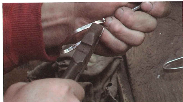
11-5 ウデマゲ ウデマゲ型からパーツをはずし、ペンチで曲げの微調整を行う
