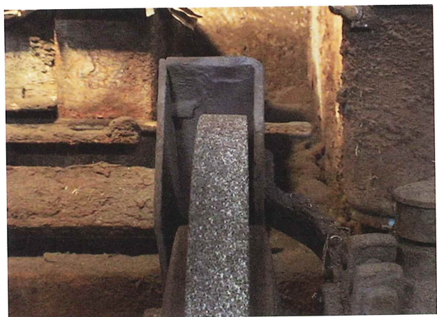
図4 斜めに調整されたグラインダー砥石面
