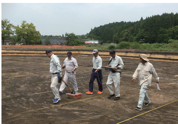
写真5 地中レーダー探査実施状況
