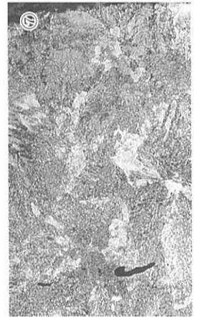
写真6 鉄片 (刃部破片) の顕微鏡組織 (原写真を70%に縮小)
