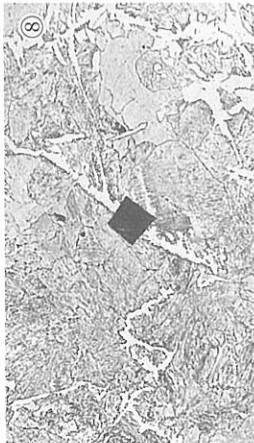
写真7 鉄片 (刃部破片) の顕微鏡組織 (原写真を70%に縮小)
