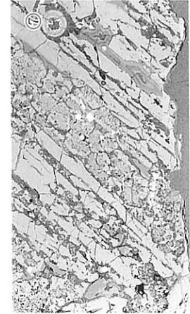
写真1 梲形鍛冶滓の顕微鏡組織 (原写真を70%に縮小)
