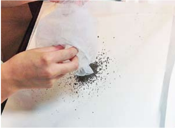
⑦浮遊物を紙の上にあける。細かいものが多い場合は、0.5mm 目のフルイを用いてフルイがけを行う。
