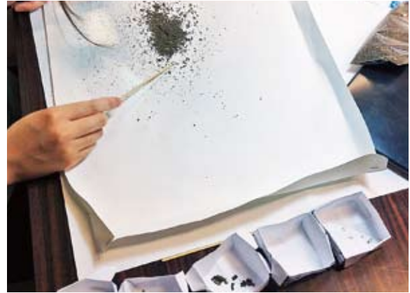
⑧フルイ回収物と同様に、種別ごとに仕分ける（抽出物は沈殿物と一緒にする）。残渣は保管する。残渣は実体顕微鏡でチェックした後に廃棄する。
