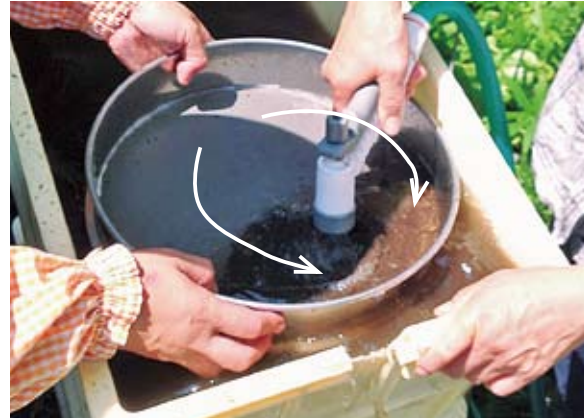
⑧フルイからの落下物がほぼなくなったら、フルイの中の残渣を水の流れとフルイの振動を利用してフルイの片側に寄せる。
