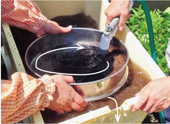
⑦シャワーの水の力でフルイ内に土壌を広げ、水をまんべんなく篩の残渣物にかけるようにする。
