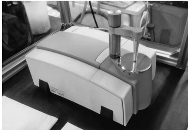
第127図 フーリエ変換赤外分光分析装置
