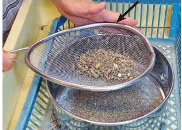
②粗い目のフルイを細かい目のフルイの上にし、乾燥フルイがけをする（乾フルイ法）。
