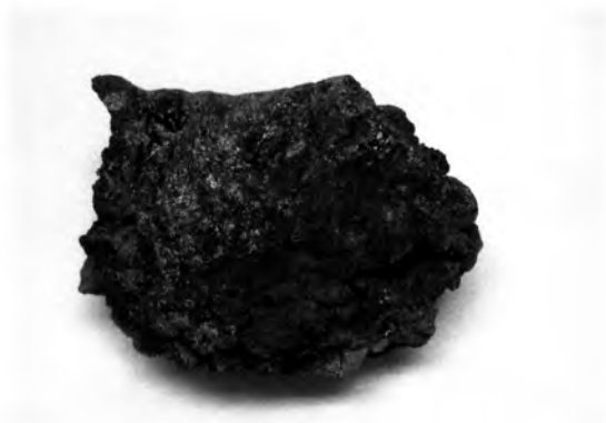
T 1 炉内面 溶湯滓付着
