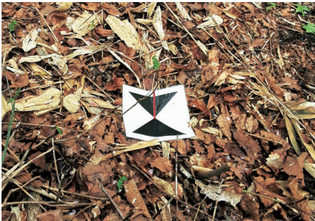
図1 計測領域に設置したターゲットマーカー
