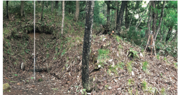
図4 オートレベルによるターゲットマーカーの水準計測
