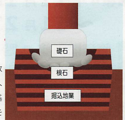
掘込地業と柱の建て方(模式図)
