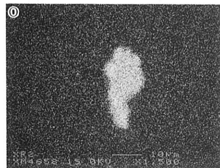
写真図版459 金箸 (OKS-25) 鉄中非金属介在物の特性X線像と定量分析値
