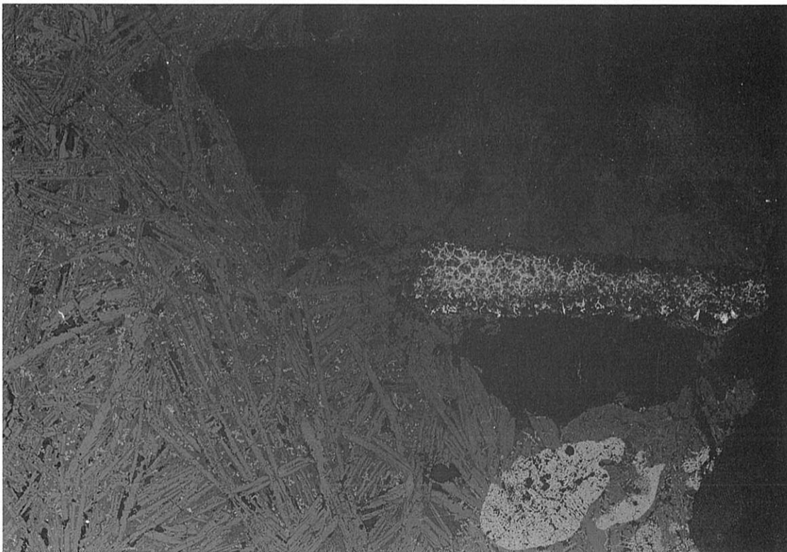
上段：鋳（OXS-5）のマクロ組織（×10） 下段：梔形滓（OXS-8）のマクロ組織（×10） 写真図版445 鉄製品のマクロ組織
