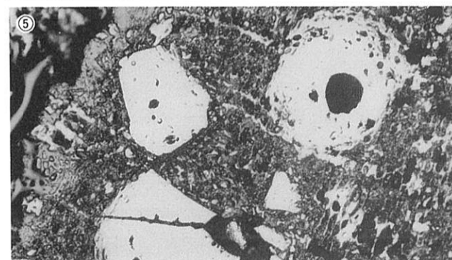
写真図版405 羽口片の顕微鏡組織
