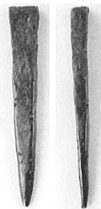
(3) IFJ-3 第8a層出土 馬鋏の歯 ①×20 マクロ組織 ②×100 ③×400 ナイタル etch パーライト浸炭組織
