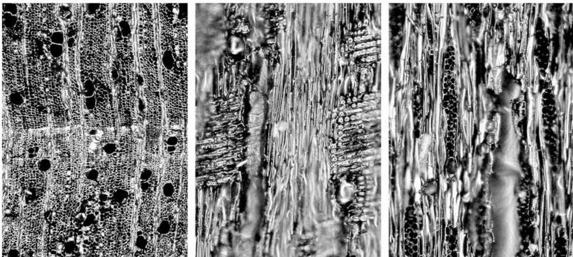
横断面 ————— : 0.4mm 放射断面 ————— : 0.2mm 接線断面 ————— : 0.2mm
