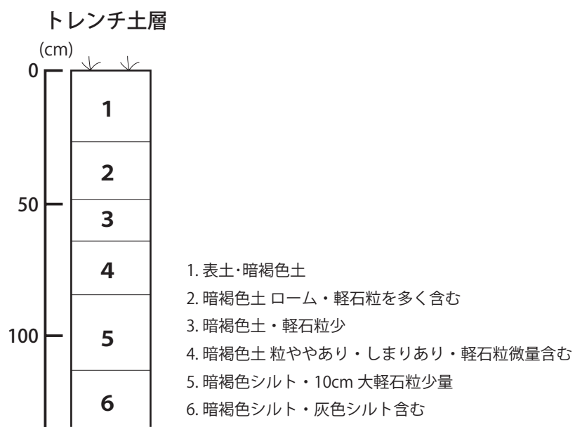
第8図 トレンチ配置図 (1/500) ・土層図 (1/20)
