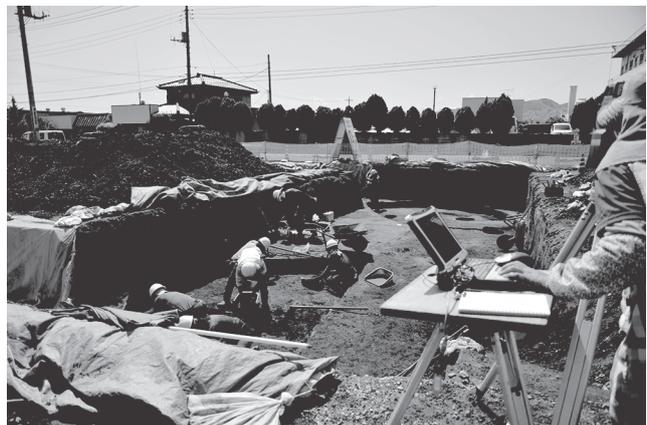
作業風景 電子平板図化システムによる計測
