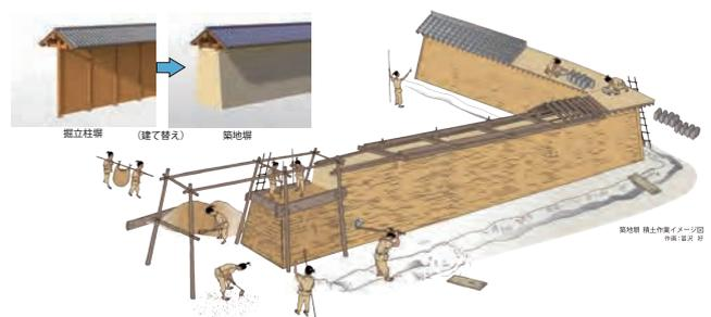
第17図 築地塀積土作業イメージ
