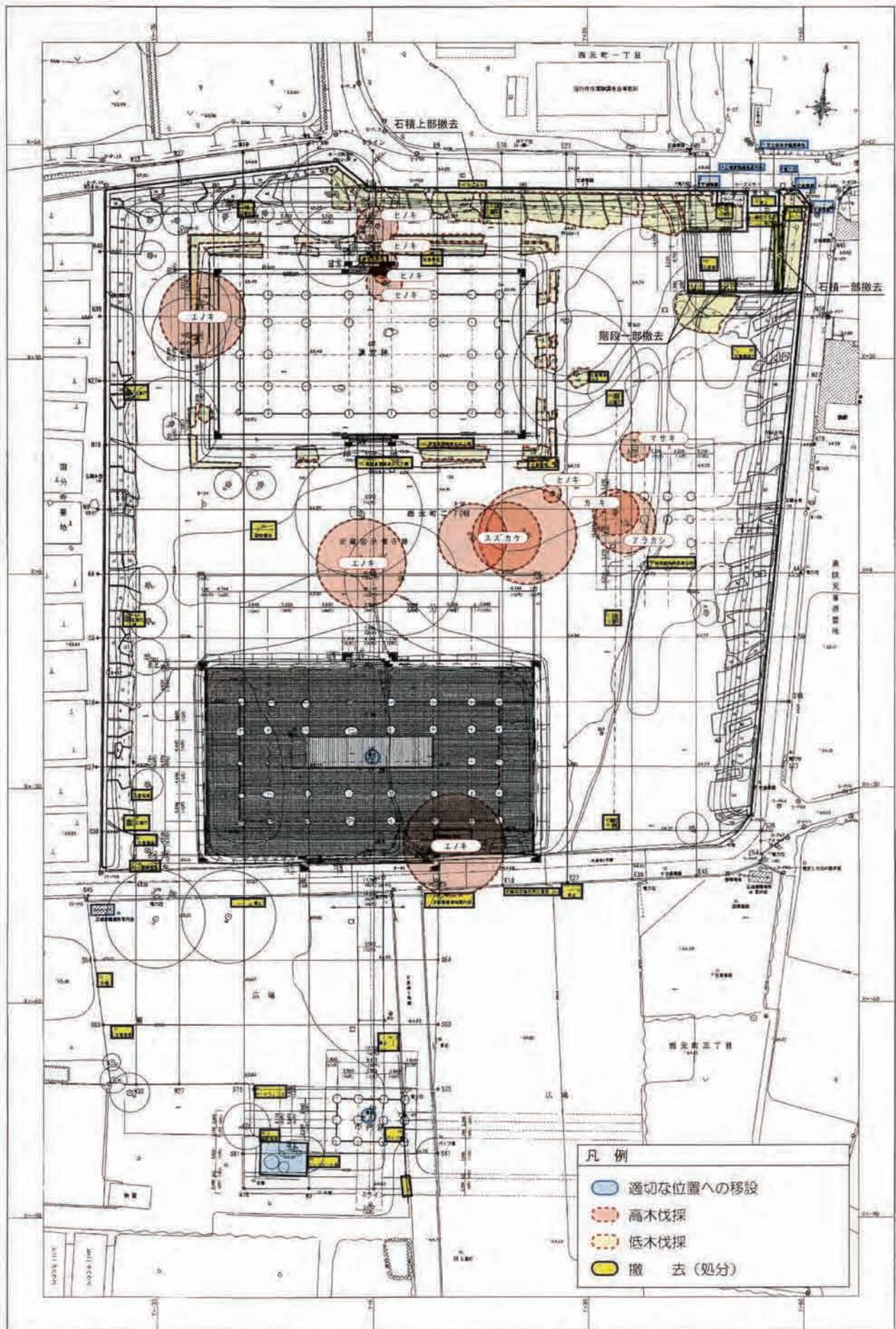
第 34 図 基本設計策定時の撤去(移設)・樹木伐採計画図
