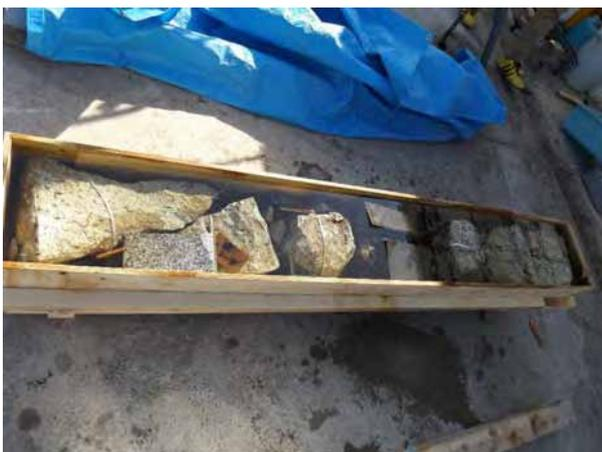
基壇部の石は、大きな箱で浸漬したので、1個ごと浸漬前後の重量を計測した
