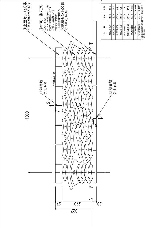
基壇外装遺構表示(復元瓦・新瓦)標準断面図(S=1:5)
