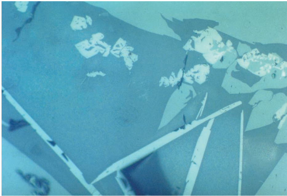
図 905 鉄滓顕微鏡組織 3-2 (試料 No.3)
