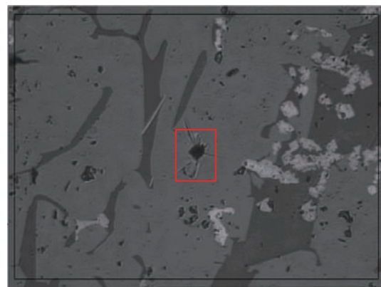
倍 v 硬度測定写真 (No.3 ファイヤライト)
