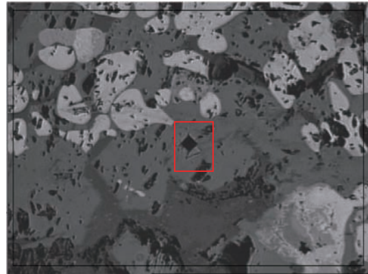
倍 v 硬度測定写真 (ファイヤライト)
