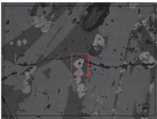
倍 v 硬度測定写真 (No.3 ウルボスピネル)
