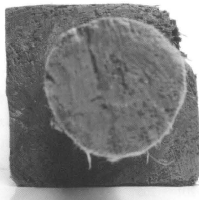
図138 井戸202隅柱. 仕口ケズリ出し面の加工痕.
