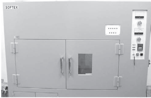
軟X線写真撮影装置
