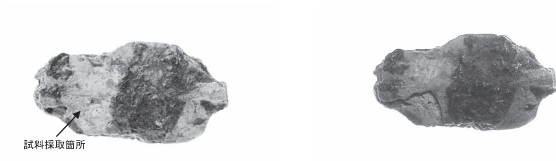
図 518 銅鏝3 (左: 試料採取前、右: 試料採取後)
