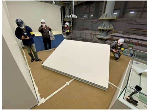
図2-25 箱型展示パネルの転倒・破損
