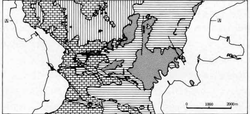
図13・沖縄市南部の表層地質図及び断面図
