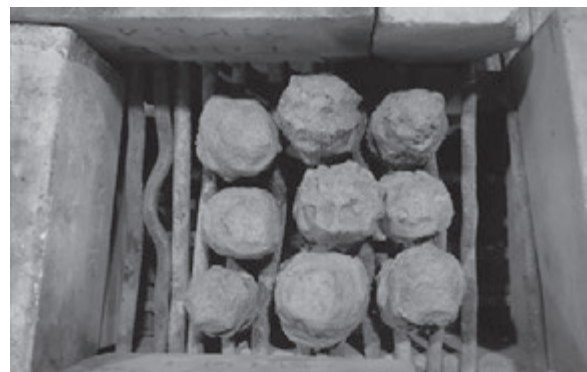
図2 炭火による脱鉛の様子
