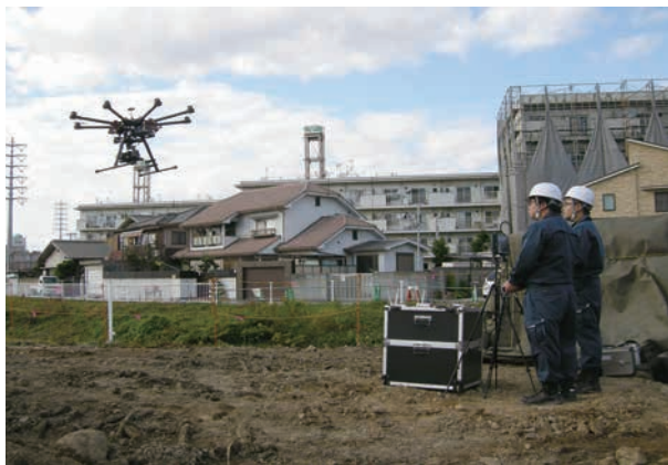
⑦ ドローンによる空中写真測量状況 (南から)
